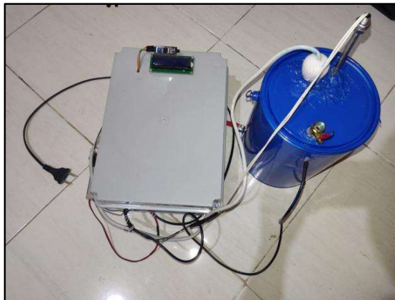
Gambar 3. 5 Miniatur / Prototype boiler berbasis Arduino Sumber: Dokumentasi Pribadi
