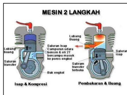
Gambar 2. 8 Siklus Mesin 2 Tak (Sumber : https://fastnlow.net/cara-kerja-mesin-2-tak-dan-4-tak/ )
