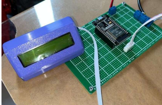
Gambar 4. 8 Pemasangan LCD I2C Sumber: Dokumen Pribadi (2025)
