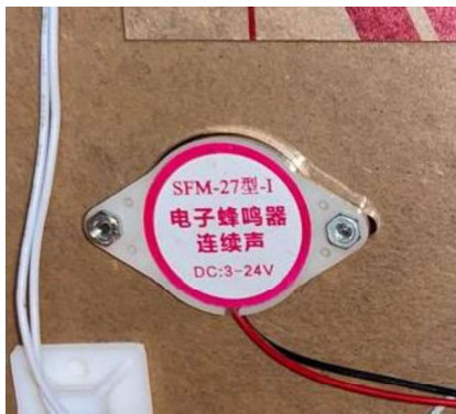
Gambar 4. 7 Pemasangan Buzzer Sumber: Dokumen Pribadi (2025)
